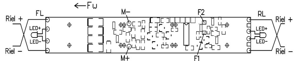
El común positivo para las funciones F5 y F6 se toma del punto de conexión LED+.
